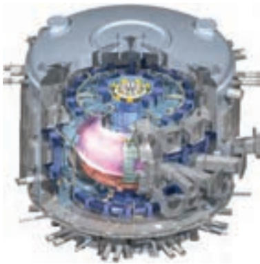
شکل ۱۵-۶ طرحی از راکتور آزمایشی گرما هسته‌ای بین‌المللی (ITER). ساخت این راکتور با مشارکت چندین کشور جهان، از سال ۲۰۰۷ در فرانسه شروع شده است و پیش‌بینی می‌شود بنای آن در سال ۲۰۲۱ به اتمام برسد. قرار است این راکتور از سال ۲۰۳۵ با توان خروجی ۵۰۰ مگاوات شروع به کار کند.
