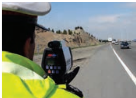
شکل ۳۰-۳ تعیین تندی خودروها به کمک اثر دوپلر
